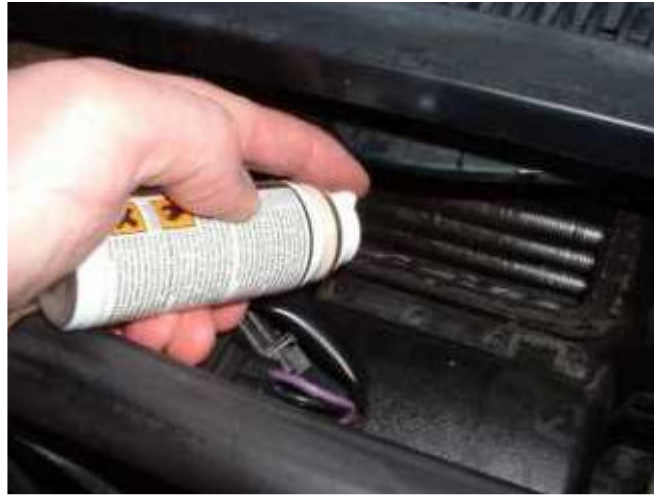
Resim 1.11: Otomobil klimalarında kirlenmiş bir evaporatörden kaynaklanan kötü kokuların giderilmesinde kullanılan bakteri ve küf oluşumunu engelleyici kimyasal uygulaması
