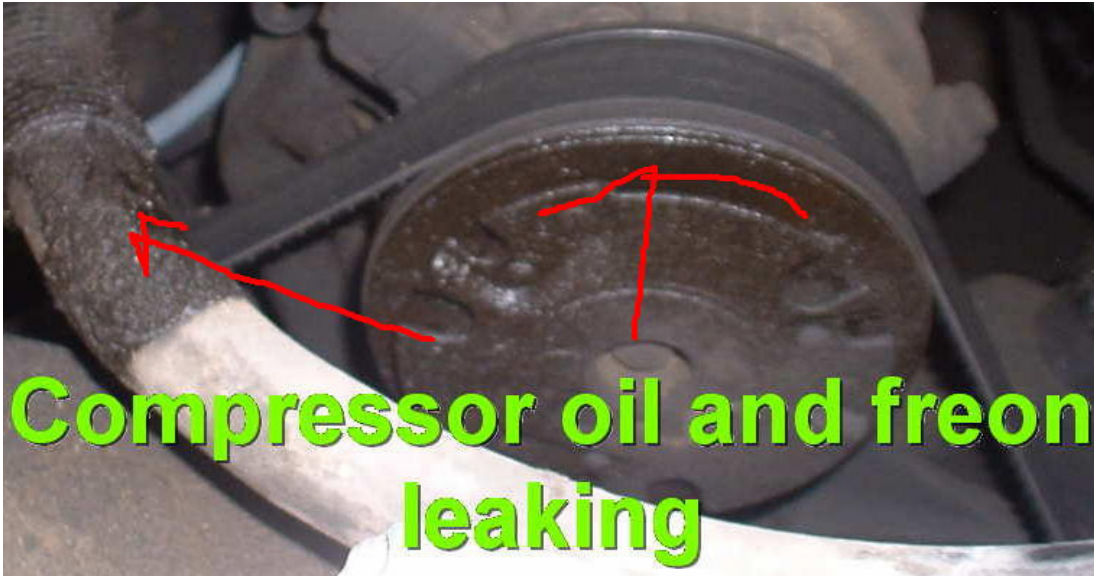
Resim 2.10: Soğutucu akışkan ve yağ kaçağının kavrama ve boru üzerindeki koroziif etkisi
