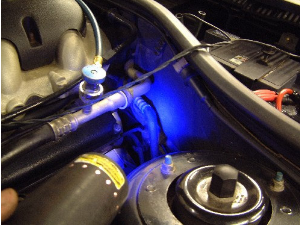
Resim 2.9 : UV ışıık ile klima devresinde soğutucu akışkan kaçak yerinin aranması
