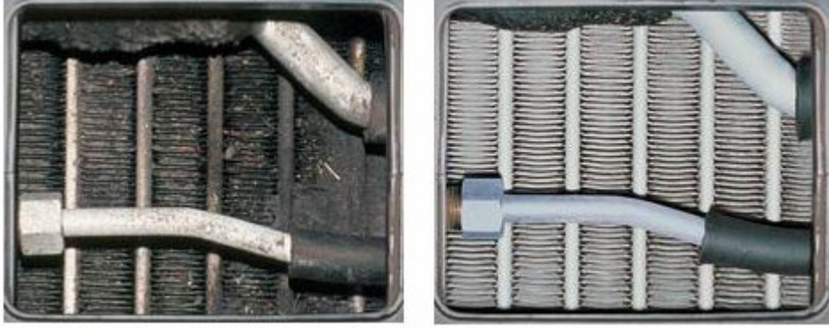
Resim 1.11: Otomobil klimalarında kullanılan kirlenmiş bir evaporatör ve temizlik sonrası görünümü
