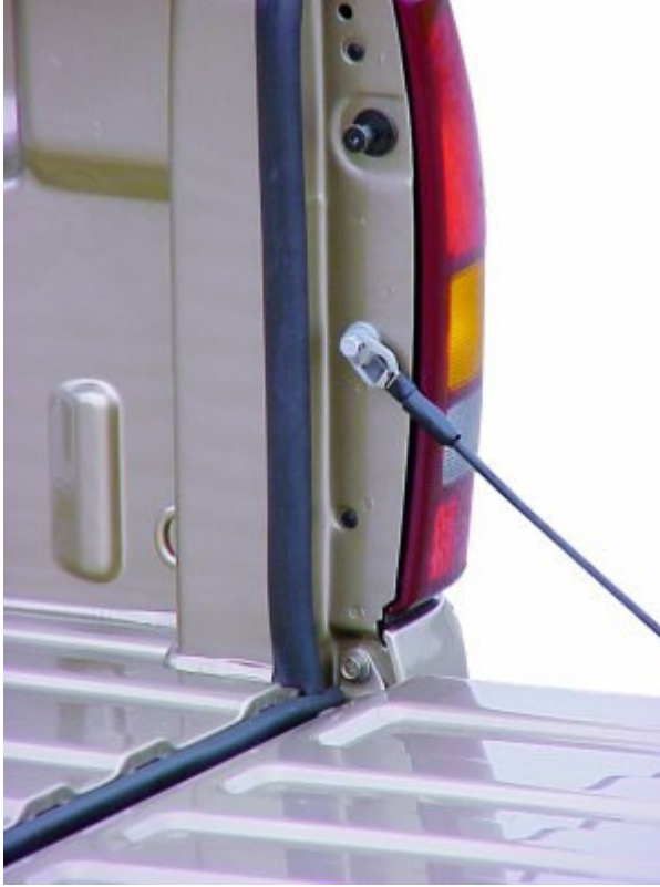
Resim 2.38: Sızdırmazlık sağlayan kapı fitil ve contalarına örnekler
