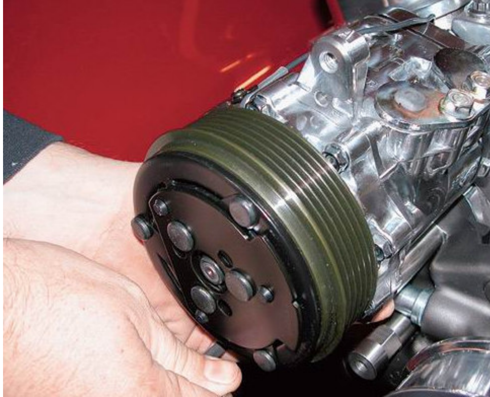
Resim 1.12: Kompresör kavraması sıkılığının sentille kontrolü
