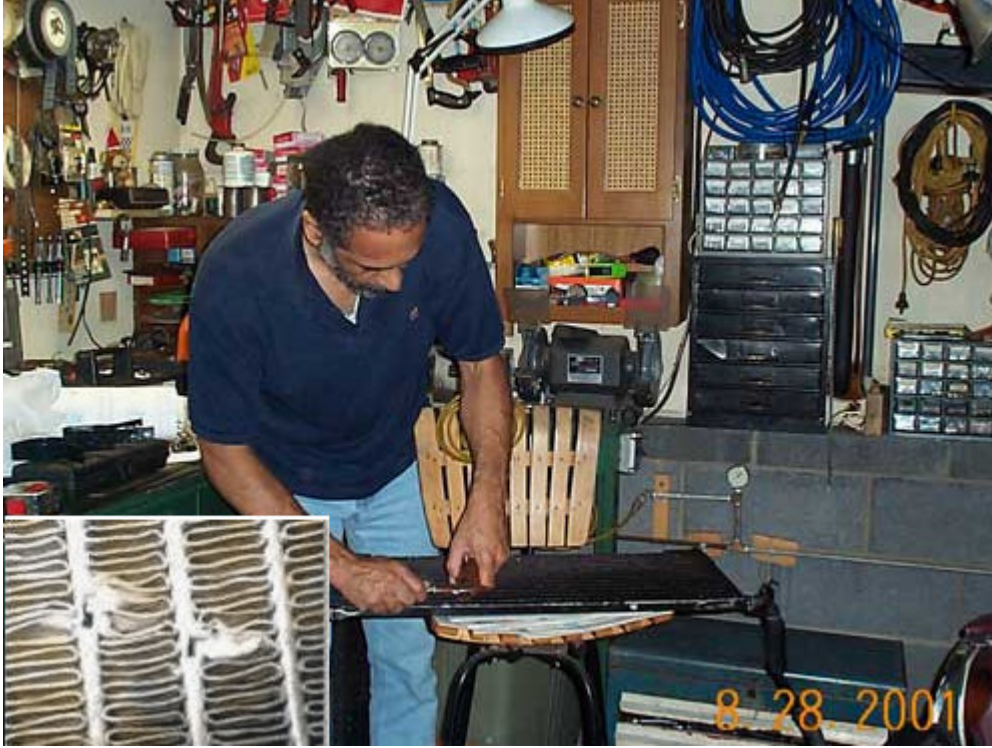
Resim 1. 8: Kondenser finlerinin/kanatçıklarının düzeltilmesi ve kondenser tamiri
