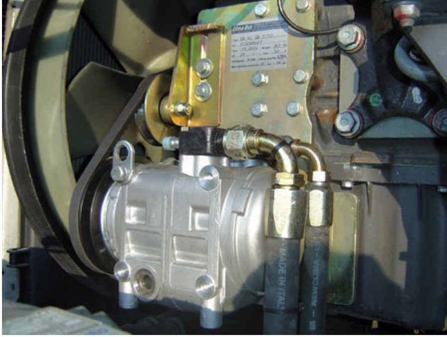
Resim 2.12: Bakımda tüm bağlantılar, boru ve hortum devresi gözden geçirilmelidir
