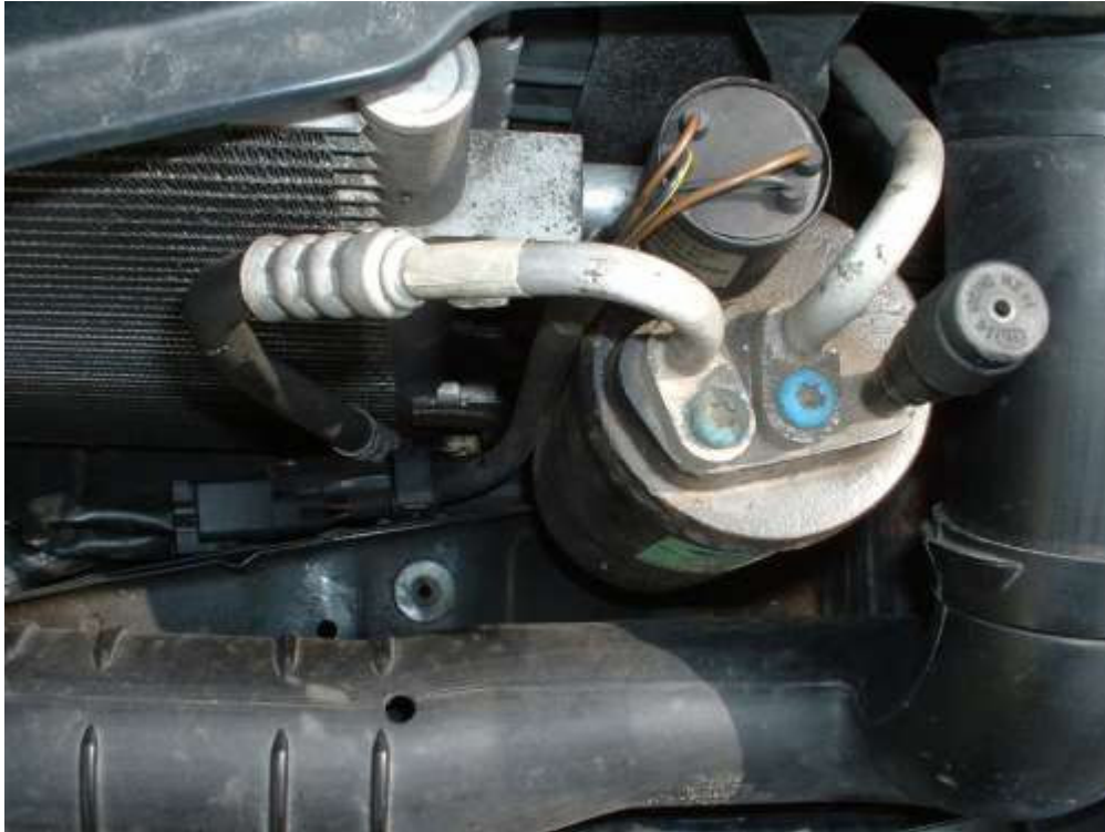
Resim 2.30: Alçak basınç hattında akümülatör üzerinde kullanılan basınç sensörü (Basınç Presostatı)
