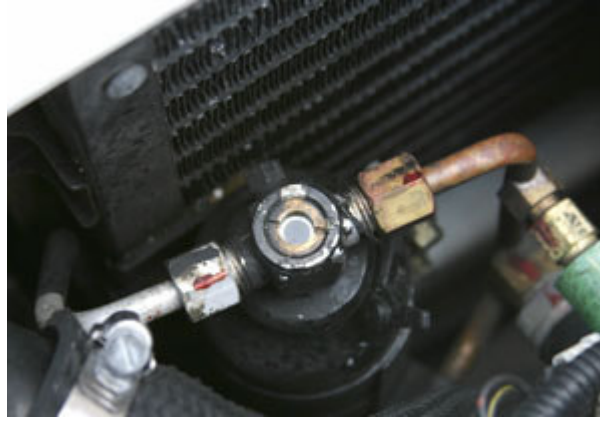
Resim 2.13: Frigorifik ve araç klimalarının soğutma sisteminde kullanılan gözetleme camı sistemin genel durumu hakkında daha sağlıklı bilgi sahibi olmamızı sağlar
