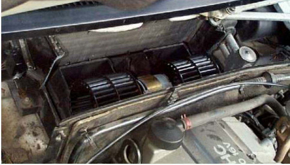
Resim 2.5: Evaporatör, evaporatör fan motoru, fanlar ve TGV montaj konumları
