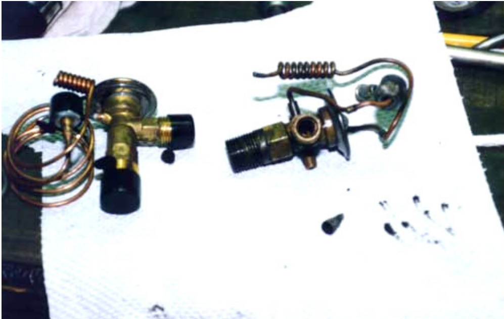
Resim 2.23: Araç klimasında kullanılan termostatik genişleme elemanlarından örnekler
