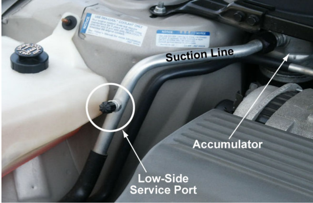
Resim 2.19: Otomobil klimasında akümülatörün devre üzerindeki konumu
