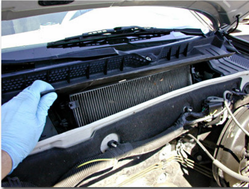
Resim 1.9: Aracın ön göğüsliğüne davlumbaz içine yerleştirilmiş evaporatör
