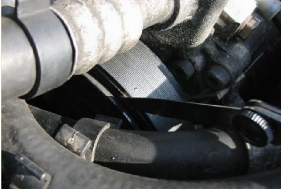
Resim 2.34: Manyetik kavrama sıklığının filer akısı (Sentil) ile ayarlanması
