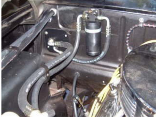
Resim 2.16: Filtre-kurutucunun otomobil klimasındaki konumu
