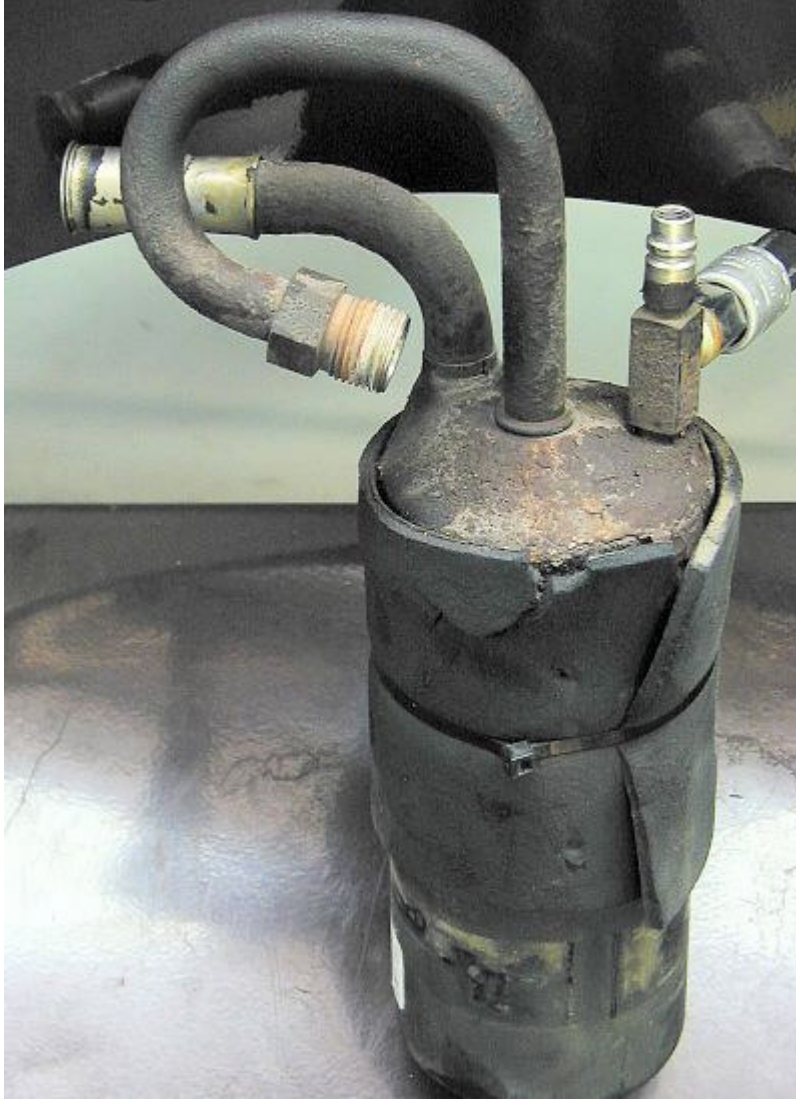
Resim 2.18: Otomobil klimasında korozyona uğramış akümülatör
