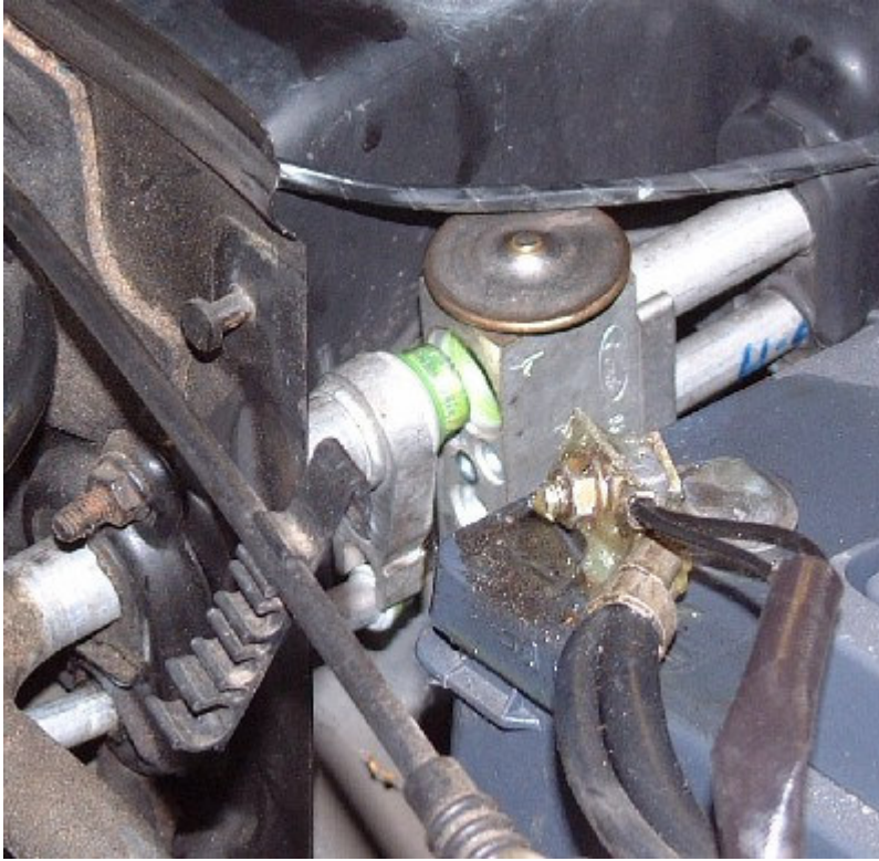
Resim 2.26: Termostatik genişleme valfi evaporatör giriş ve çıkış bağlantısı, montajı
