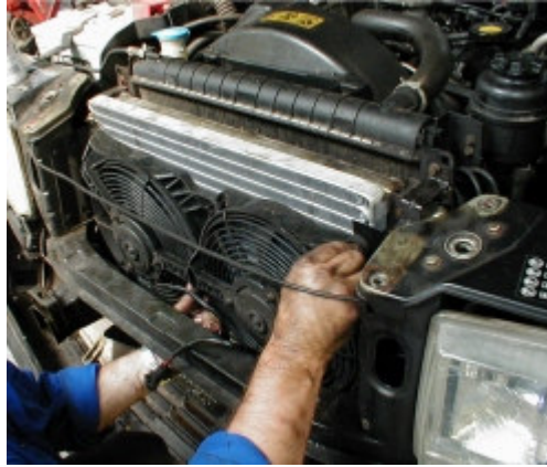
Resim 1.4: Otomobil kliması kondenser fanları
