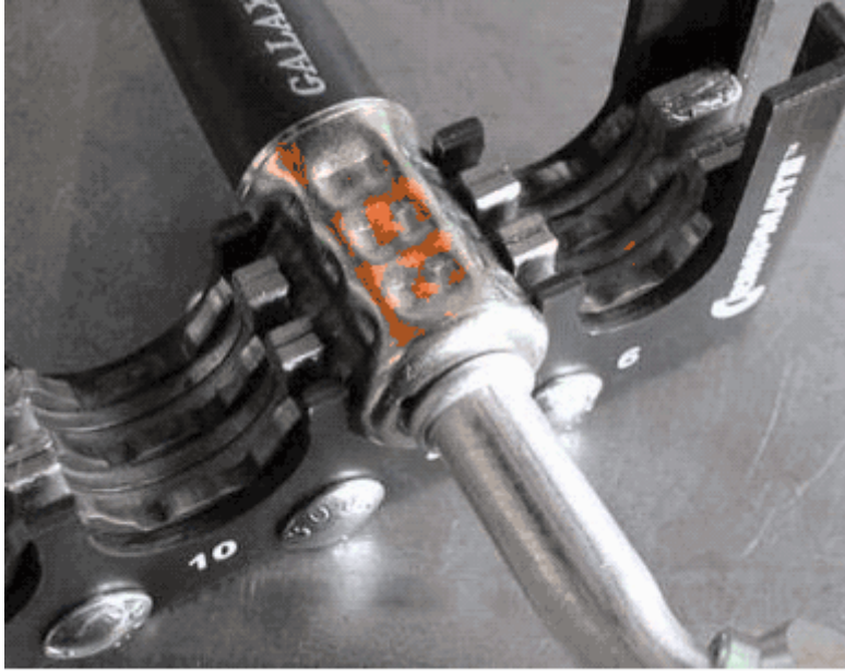
Resim 2.9 : Presli birleştirme tekniğine ait uygulama
